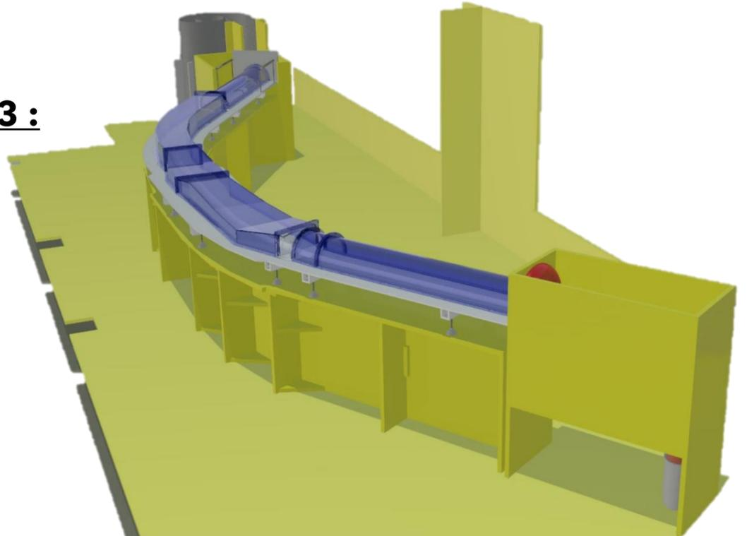
J'ai conçu le support de la structure en panneau de coffrage ainsi que les bassins d'admission et de récupération de l'eau. Le système de soutien de la galerie est réalisé avec un dispositif de pied de machine. La fabrication de la galerie est en PVC transparent bleu pour les toits et en PVC gris pour les fonds. Deux pièces ont du être imprimées en 3D à cause de leurs géométries complexes.
